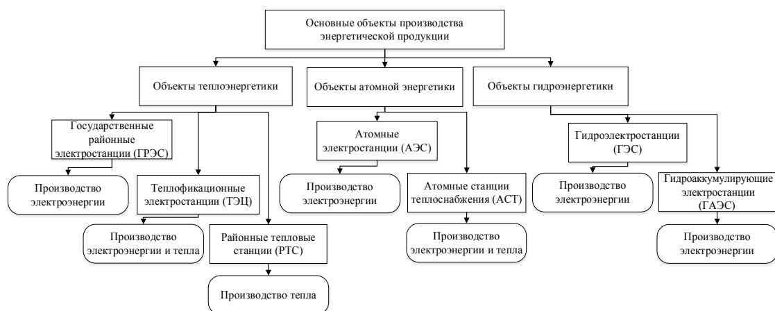
Рис. 3. Основные производственные мощности общенергетической системы, используемые для производства энергетической продукции
