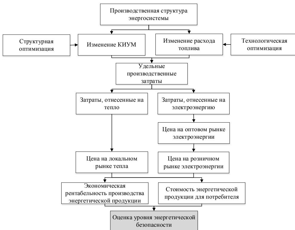
Рис. 7. Алгоритм оценки влияния повышения эффективности производственной структуры энергосистемы на уровень энергобезопасности
